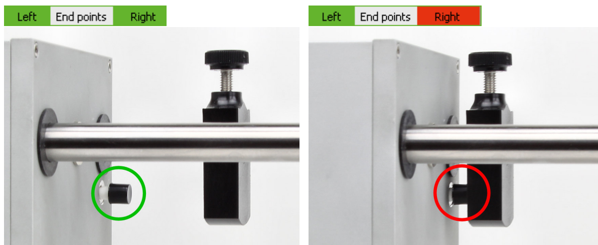
Abb. 68: Statusanzeige in der Software GS-EchoView und Position der Endlagenschalter: links Schalter frei (AUS) und rechts in Anschlagposition (EIN)
