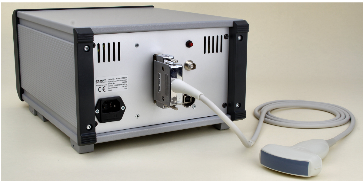
Abb. 13: Anschluss des Arraywandlers auf der Rückseite des GS200i.
