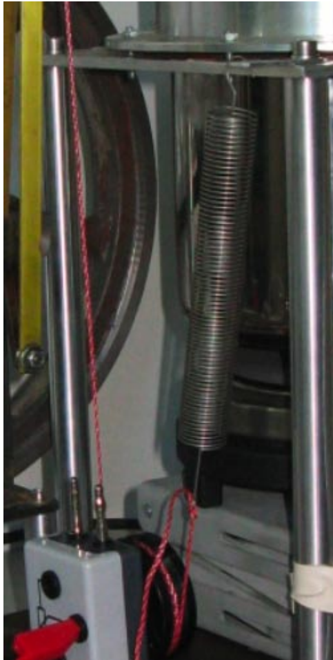
Abbildung 8: Mittels dieser Feder bleibt der Faden auf der Potentiometer-Rolle gespannt.
