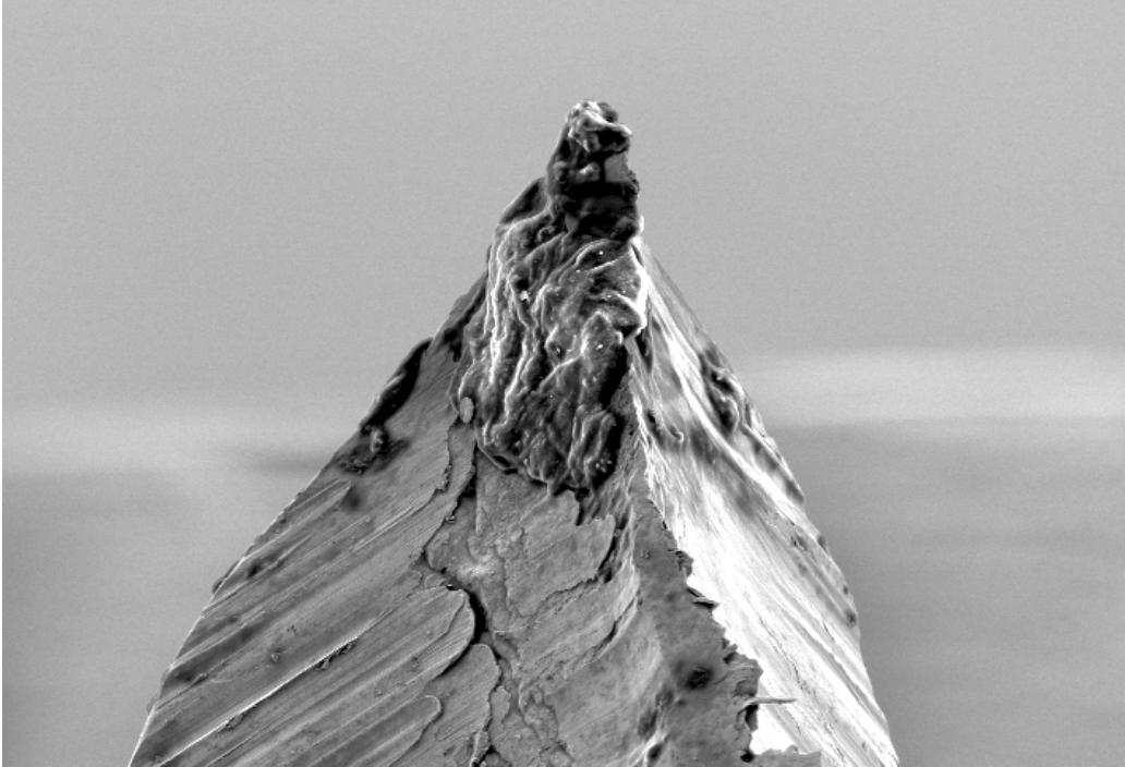
Figur A1.7. Messspitze aus Pt-Ir ca. 200-fach vergrößert.
