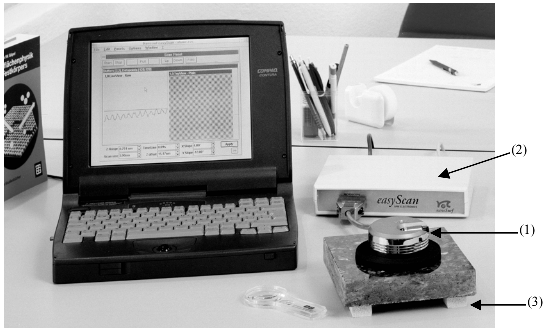
Figur A1.1: Das RTM besteht aus dem Messkopf (1), der Elektronik (2) und dem Computer. Unter dem Messkopf ist die Gummimatte (schwarz) zu sehen. Die Steinplatte ist auf vier Gummifüsse (3) gestellt.
