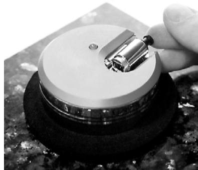
Figur A1.8. Sorgfältige Platzierung und Verschiebung des Probenhalters.
