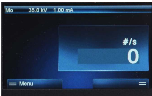
Abb. 10: Bildschirm zur Gerätesteuerung an der Vorderseite des Gerätes. Hochspannung ist nicht aktiviert.
