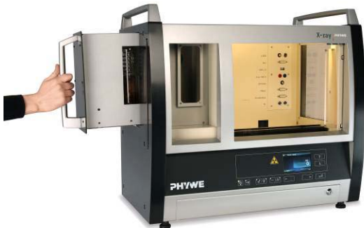
Abb. 6: Röntgeneinschub an der linken Seite des Gerätes
