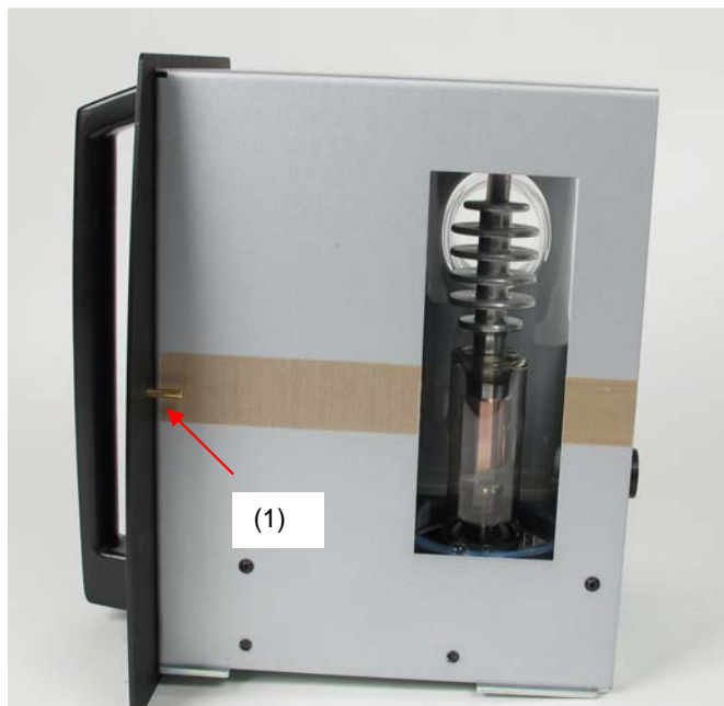
Abb. 2: Seitenansicht der Röhreneinschübe
