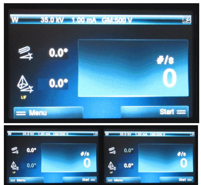
Abb. 4: oben: gekoppelter Modus, links: Detektor drehen, rechts: Kristall drehen.
