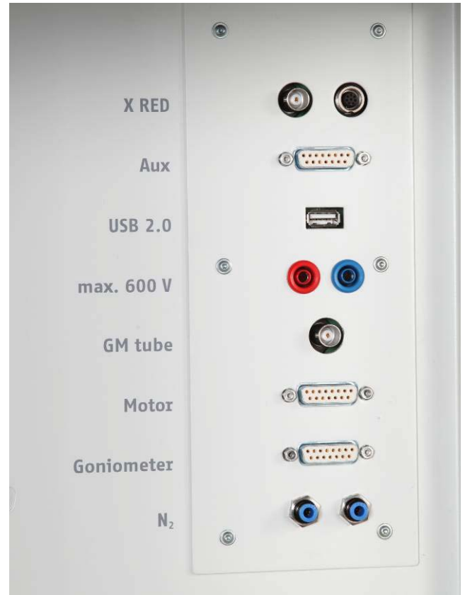
Abb. 7 Buchsenfeld im Experimentierraum
