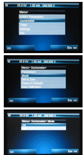
Abb. 3: Aktivieren des Goniometer-Modus
