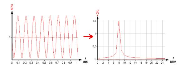
Beispiel: Fourier-Spektrum einer zusammengesetzten sinusförmigen Welle:
