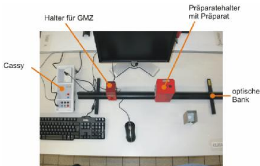
Abb. 14: Aufbau für Messungen mit einem Geiger-Müller-Zählrohr.
