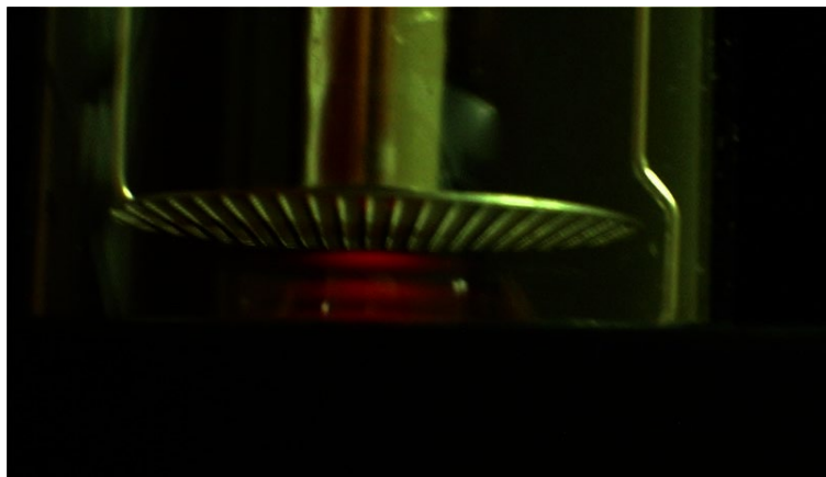
Abb. 5: Drei Leuchtschichten beim Franck-Hertz-Versuch mit einer Neon-Röhre.
