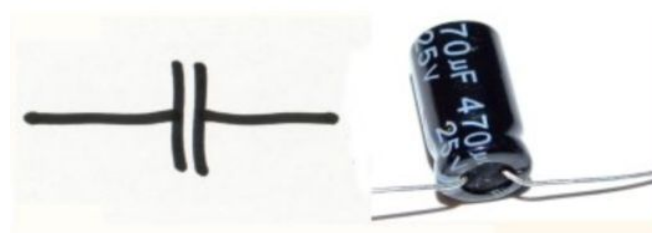
Abb. 5: Kondensator (rechts) und sein Schaltsymbol (links).
