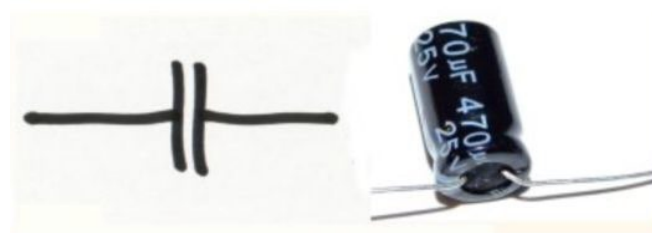
Abb. 5: Kondensator (rechts) und sein Schaltsymbol (links).
