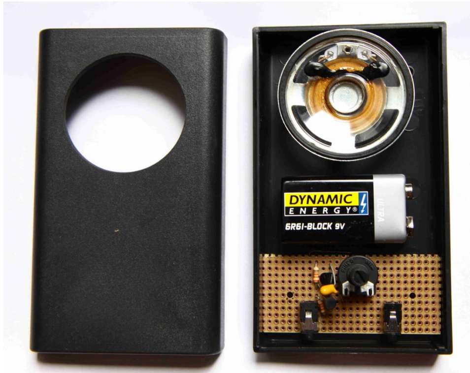
Abb. 14: Soundmodul mit Lautsprecher und Batterie in Gehäuse eingebaut.
