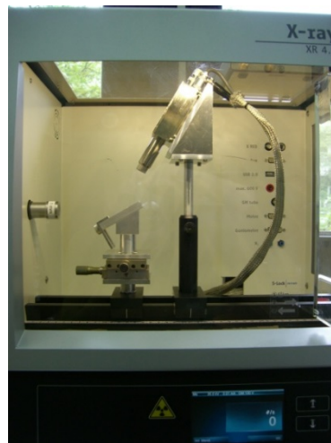
Abb. 10: Aufbau des Versuchs in der Messkammer des Röntgengeräts.
